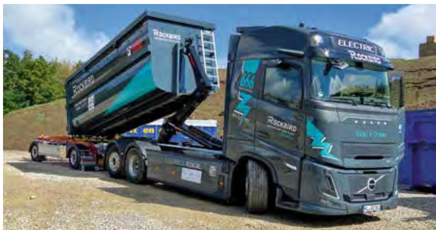
Die beiden Hinterachsen verkraften zusammen technisch bis zu 20,5 Tonnen Last
