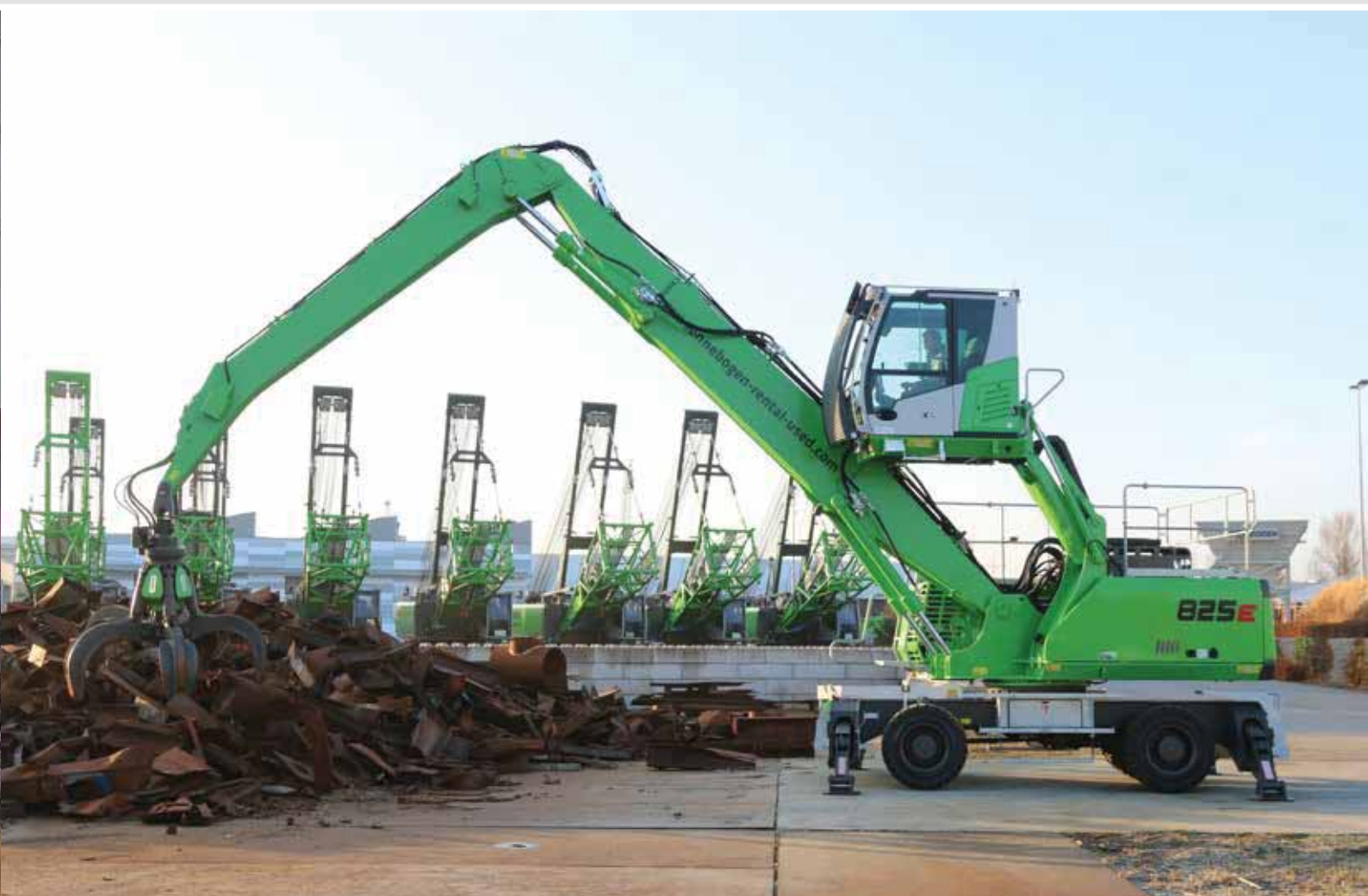
825 M -Mobiler Schrottschlag mit original SENNEBOGEN Mehrschalengreifer; Deutschland
